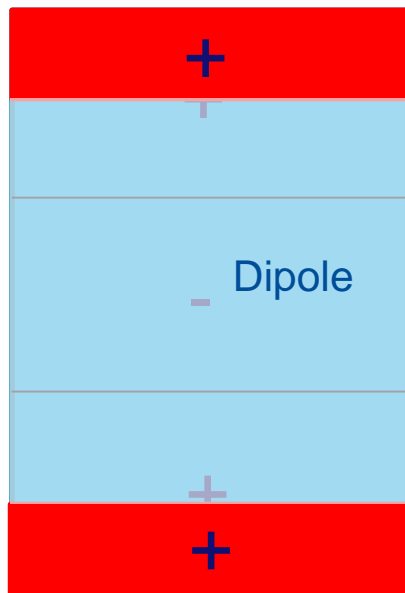
Odd mode= Edge radiation
