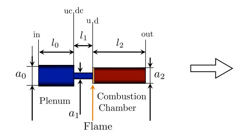
$$T(s) = T_{\rm D2}T_{\rm F}T_{\rm D1}T_{\rm C}T_{\rm D0}$$
