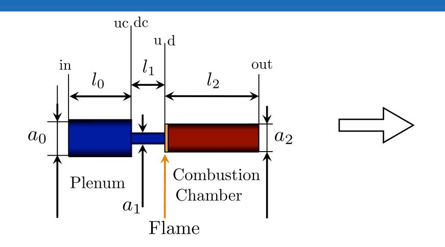
$$\begin{bmatrix} f_{\text{out}} \\ g_{\text{out}} \end{bmatrix} = \begin{bmatrix} T_{11}(s) & T_{12}(s) \\ T_{21}(s) & T_{22}(s) \end{bmatrix} \begin{bmatrix} f_{\text{in}} \\ g_{\text{in}} \end{bmatrix}.$$
